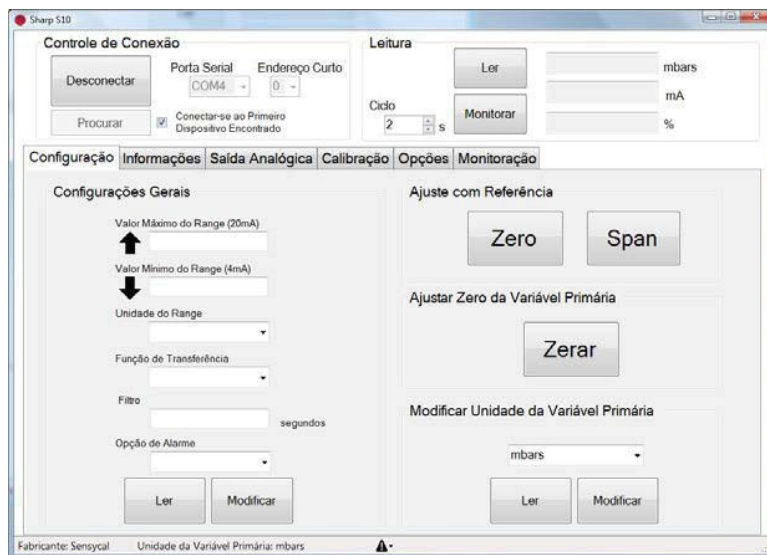
Figura 13 – Configurando os parâmetros do transmissor
