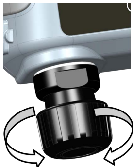
Figura 1-7: Ajuste de volume do DPI611
