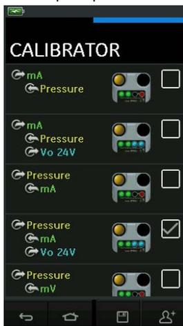
**Figura 2-9: Calibrador com opção selecionada**
