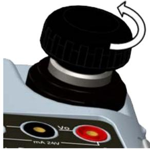
Figura 2-4: Válvula de escape de pressão
