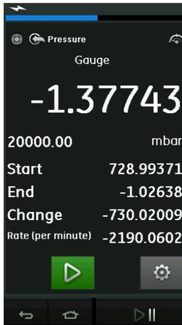
**Figura 2-26: Exemplo de teste de vazamento**
