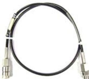
Uma mangueira pneumática de alta pressão a 400 bar (5.800 psi). A mangueira conecta-se diretamente à porta de pressão do DPI612 e replica a conexão de encaixe rápido, oferecendo compatibilidade com os adaptadores padrão fornecidos e outros kits de adaptadores.
