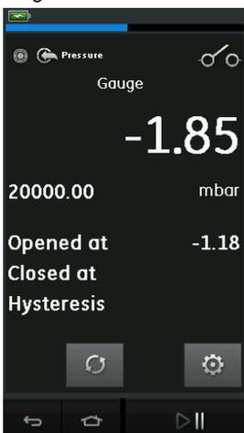
Figura 2-14: Exemplo de teste de chave
