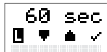
Tela de configuração de teste de vazamento
