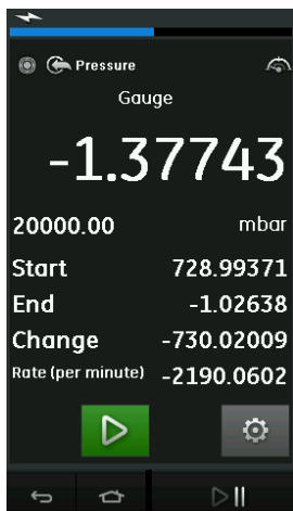
Figura 2-24: Exemplo de teste de vazamento
