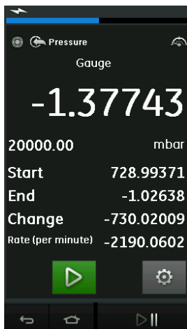
Figura 2-26: Exemplo de teste de vazamento
