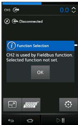
Figura 11-1: Função CH2 não definida quando o Profibus® está ativado
