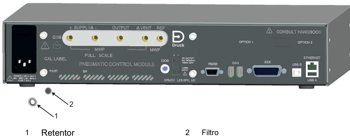
Figura 4-2: Troca do filtro do Módulo de Controle de Pressão
