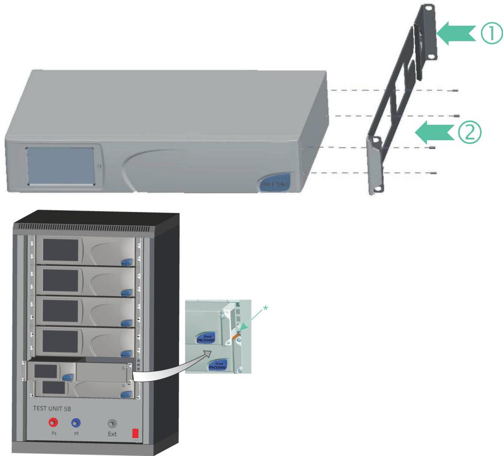
Figura 2-8: Montagem em prateleiras
