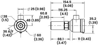
1/2 NPT Conduit Adapter Use to adapt the standard M20 x 1/5 conduit connection.
