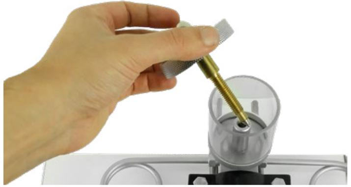
5. Preencha o reservatório com fluido (água destilada, óleo hidráulico ou mineral). Ao finalizar, rosqueie parcialmente a tampa do reservatório, quase até o final do curso, porém mantenha o reservatório ainda aberto.
