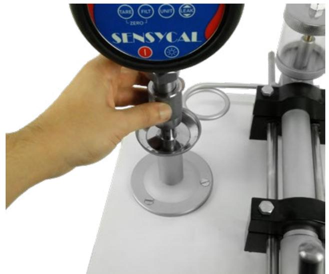
3. Conecte o padrão comparativo na conexão ajustável direita.
