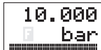
Gráfico de barras com 50 segmentos indica pressão de 0 % até 100 % da faixa de medição
