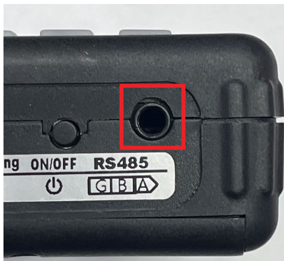
Figura 127 - Porta RS485 na parte inferior do MCS375
