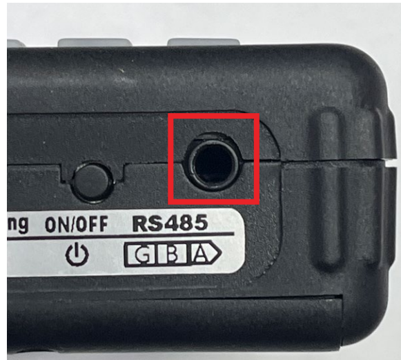
Figura 127 - Porta RS485 na parte inferior do MCS375
