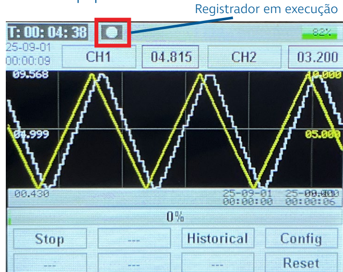
Figura 115 - Registrador em execução
